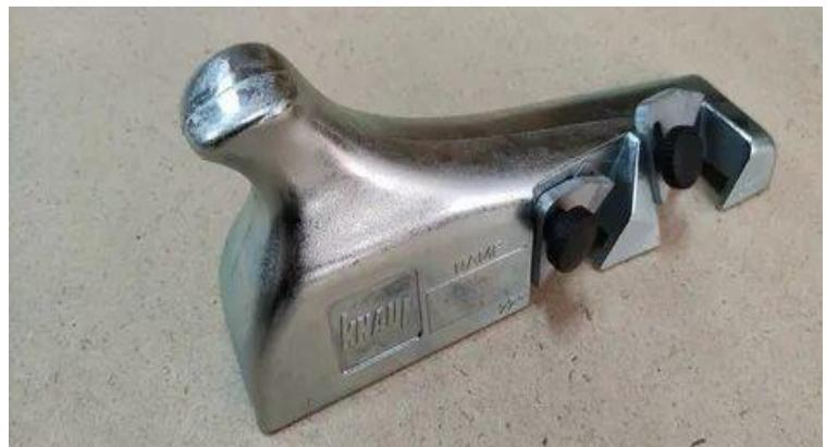
**Особенности.** У кантенхобеля лезвие имеет трапециевидную форму. В некоторых моделях может быть два лезвия, которые находятся под углом относительно боковой стороны подошвы. В зависимости от установки ножа получается срез по кромке под углом, например, в  $22,5^\circ$  или  $45^\circ$ . Таким образом, удается добиться необходимого угла кромки длястыковки заготовок по всей длине, что исключает зазоры и неровности. Такой инструмент еще называют кромочным рубанком.
