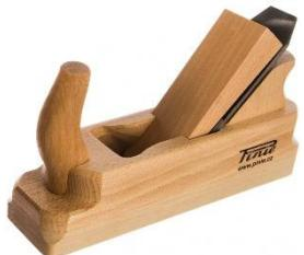
**Особенности.** Имеется двойной нож со стружколомом на кромке, который установлен под углом в  $50^\circ$  относительно подошвы рубанка. За счет этого удается застругивать задиры, неровности, сглаживать торцы и получать идеально ровную поверхность.
