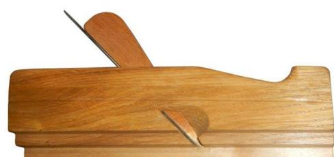
**Особенности.** Инструмент имеет ступенчатую подошву и широкую колодку. За счет этого удается выполнять пазы одинакового размера без предварительной разметки. Для выборки фальцев разных размеров и профиля у некоторых фальцгебелей предусмотрена замена ступенчатой подошвы. Есть возможность установить дополнительное боковое лезвие для подрезки вертикальной стенки четверти.
