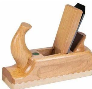
**Особенности.** Помимо основного лезвия рубанок имеет стружколом. Его нижняя кромка находится на расстоянии 0,2 – 2 мм от основной режущей кромки и установлена параллельно ей. Чем меньше расстояние между кромками, тем чище
