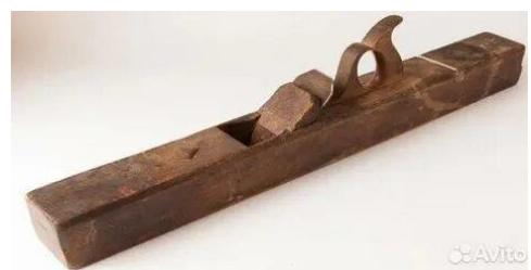
**Особенности.** Нож имеет стружколом, что обеспечивает наиболее эффективную чистовую обработку древесины. Колодка в 2 раза длиннее, чем у обычного рубанка. Это позволяет обрабатывать большие поверхности. При первых движениях стружка снимается кусками, затем образуется непрерывная – это свидетельствует о выравнивании заготовки.
